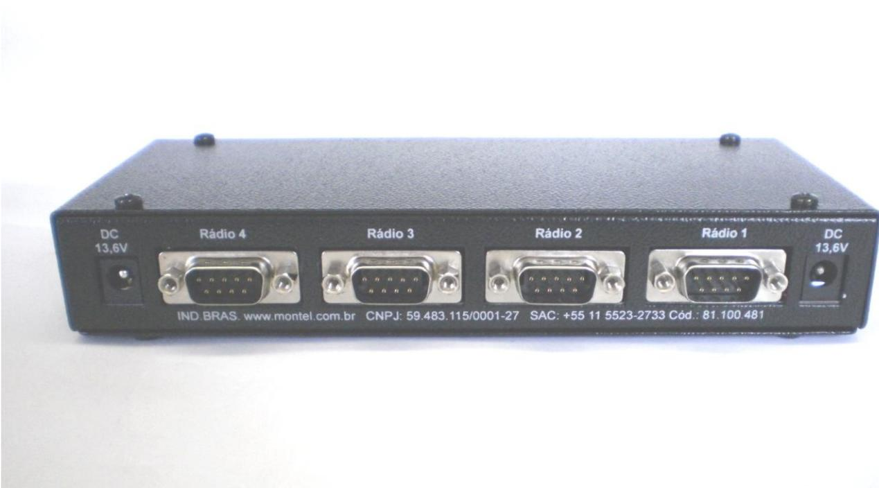
A Controladora MTCOR4 é um equipamento destinado a fazer interface entre rádios através de uma repetidora, podendo gerenciar até 4 rádios utilizando-os tanto como repetição local quanto para link entre repetidoras, se trata de um equipamento com funcionamento simplificado, de utilização muito fácil, sem aqueles inúmeros recursos quase que irrelevantes para o trabalho de uma repetidora profissional.
